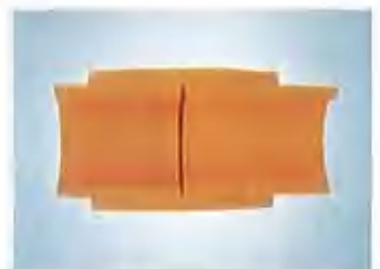
电容焊接件解剖图
